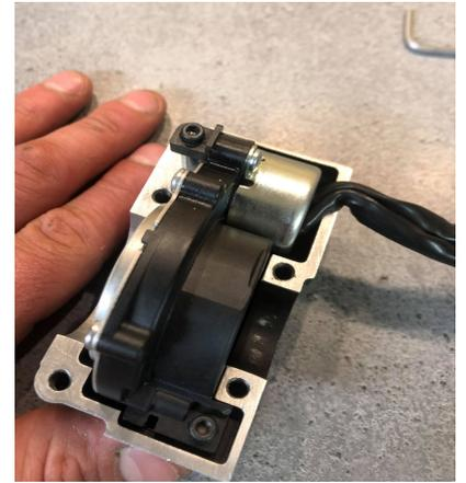
Trouvez les deux mini gaines cachées dans la gaine principale , placez les au ras du potentiomètre avant de le placer dans le corps aluminium , et serrez les vis M3 doucement
