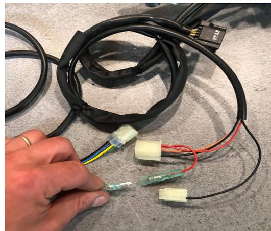
Placez un dernier rilsan pour rejoindre les faisceaux , Le boîtier de navigation sera alimenté en 12 volts par la fiche banane qui relie les deux faisceaux (commodo et boîtier )
