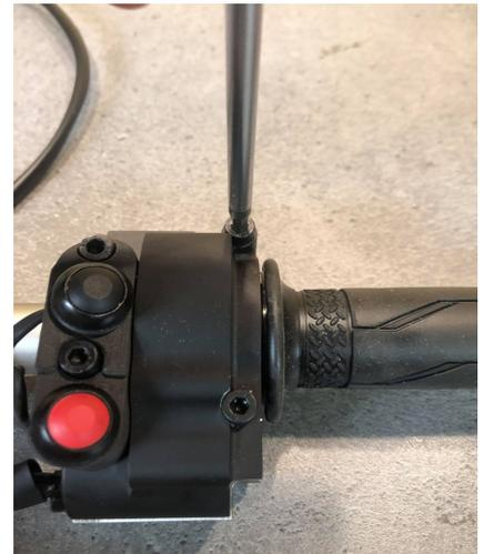
Sécurisez avec un rilsan , refermez le corps de gaz aluminium , placez le mini commodo , serrez les vis M5 modérément
